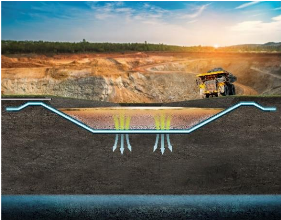
Kuva 29. Suotovesi virtaa putkesta käsittelyaltaaseen, jonka pohja on päällystetty Tektoseal Active HM -matolla.
