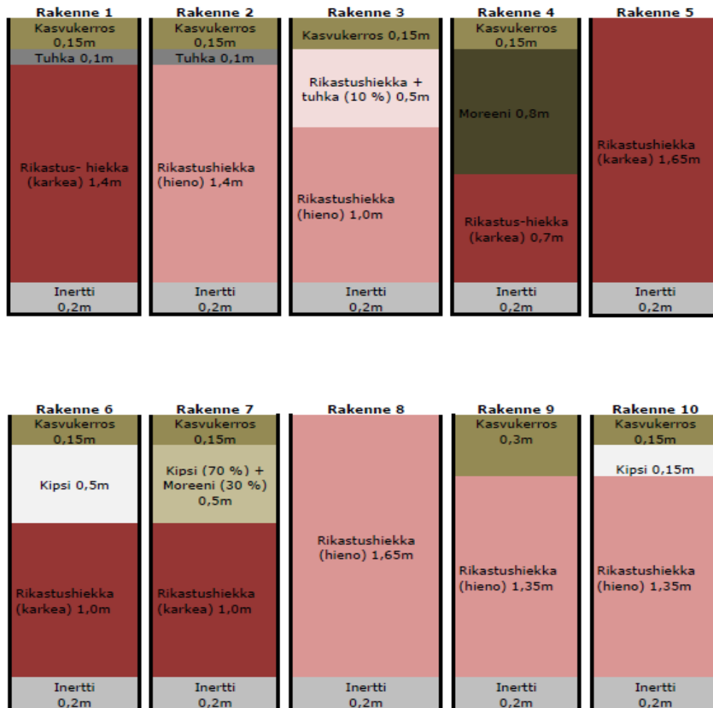
Kuva 22. Pyhäsalmen pintarakenteen pilotoinnin materiaalikerrokset.
